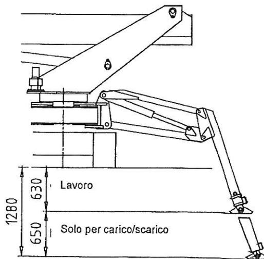
Fig. 1b -- Posizione stabilizzatori
